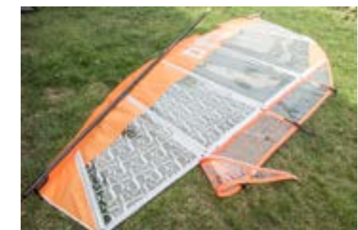
▲ Seglet har lottor i båda delarna som överlappar över blixtlåset. Att minska seglet tar bara ett par sekunder och akterliket kan rullas ihop och fästas på brädan.
