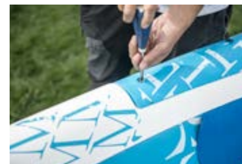
▲ Två skruvar på sidan och en sprint i aktern håller ihop brädan. När du står på brädan och surfar märker du inte att den består av flera delar.
